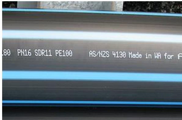
Şəkil 8. PE boru nişanlanması
