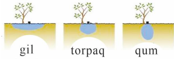
Şəkil 5. Müxtəlif strukturlu torpaqlarda suyun hopma forması
